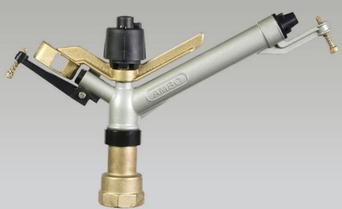
**Irrigatore di media portata** a funzionamento circolare o a settori. E' dotato di ugelli intercambiabili e di un rompigitto a penetrazione regolabile, che assicura una precipitazione fine e uniformemente distribuita. Tra le sue caratteristiche spiccano in particolare la grande semplicità dei meccanismi e la straordinaria versatilità d'impiego. E' adatto per qualsiasi tipo di impianto e si presta per terreni di qualsiasi natura ed estensione.
